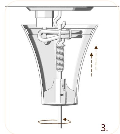
Vissez le lamptop sur le pendant. Il est alors dirigé droit vers le haut et avec le crochet comme ancrage, il plaque parfaitement au plafond.
